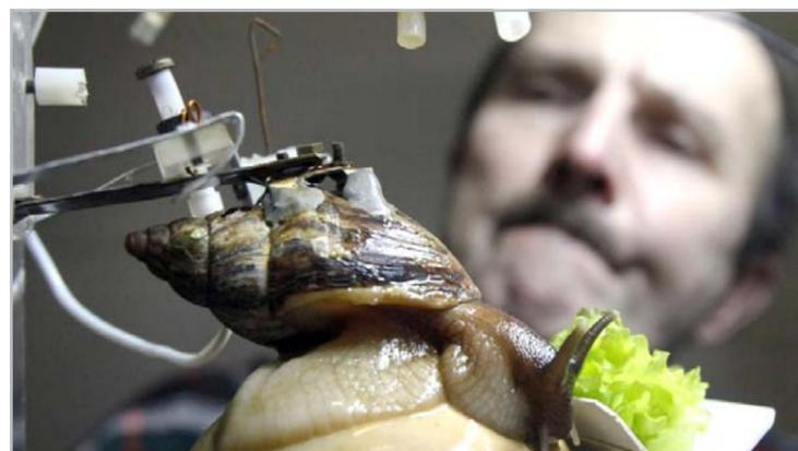
только организм животного-биоиндикатора одновременно оценивает совокупность всех качественных характеристик воды, в которой он живет. Благодаря биоэлектронной системе контроля с помощью реакций животных можно учитывать синергизм одновременного воздействия многих факторов, в результате которого качество воды, как среды обитания раков, может резко ухудшиться. При этом традиционно измеряемые физико-химические характеристики воды могут оставаться в пределах обычных суточных изменений.
